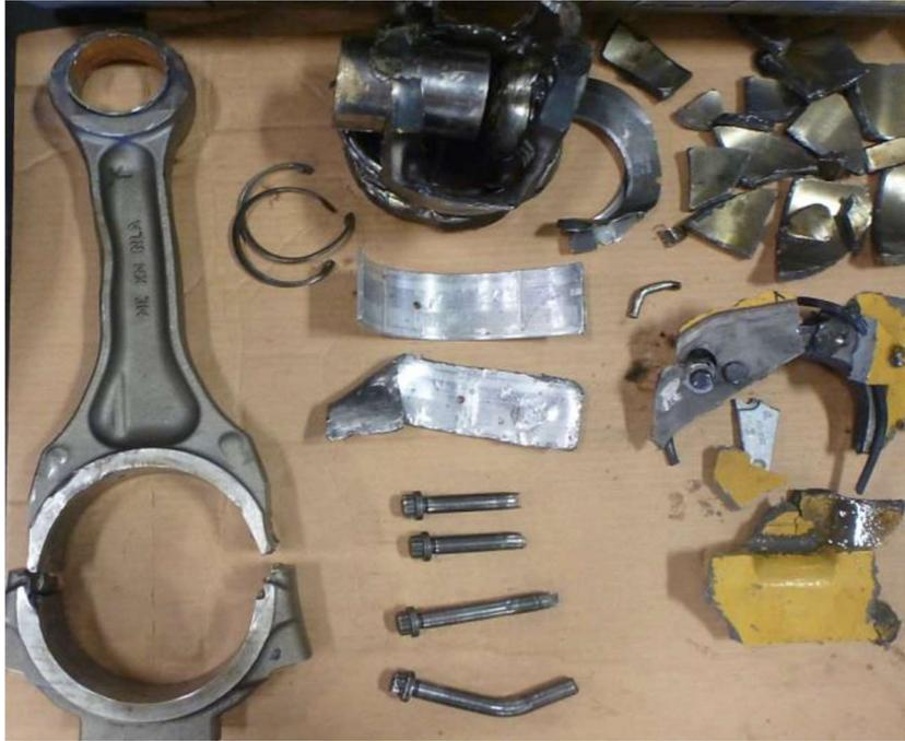
Figura 15 – Conjunto de peças metálicas danificadas do MDG2 (MAB1902, 2019).
